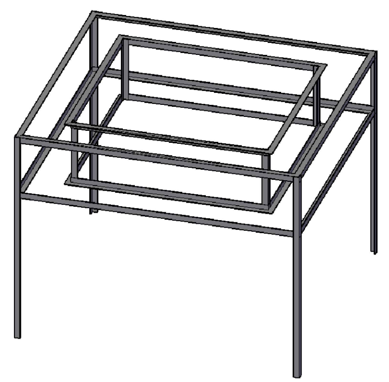
Обвязка блоков ФБС уголком 50х50х5
